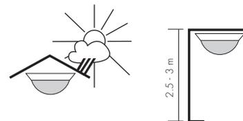
Se possibile, installare l'apparecchio in un luogo protetto alla parete a un'altezza di 2,5 fino a 3 m. È necessario fare attenzione al campo libero, poiché i raggi infrarossi non possono penetrare attraverso oggetti solidi né attraverso i vetri.
