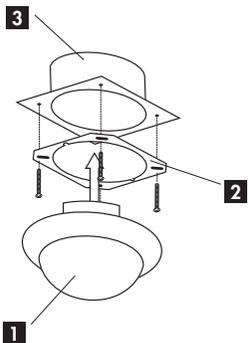
1. Sensore base per montaggio sotto intonaco
