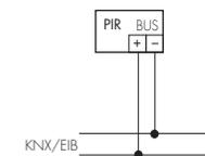
Tutti i componenti utilizzabili in combinazione con i rilevatori KNX, come ad esempio attuatori, pulsanti, ecc. comunicano con il rilevatore esclusivamente attraverso il BUS KNX.
